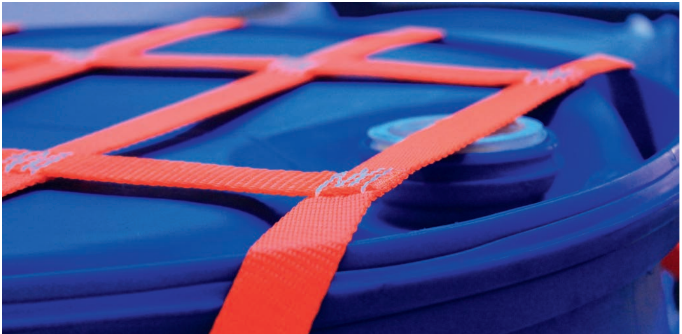
exemple: filets de sécurisation de la charge pour retenir la cargaison
